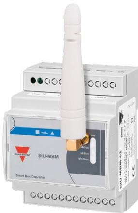
Der Gateway/Empfänger SIU-MBM-O2 von Carlo Gavazzi kann bis zu 20 drahtgebundene und bis zu 32 drahtlose M-Bus-Geräte verwalten sowie die empfangenen Daten von diesen Geräten über Modbus TCP/IP (Ethernet-Port) weiterensenden.
